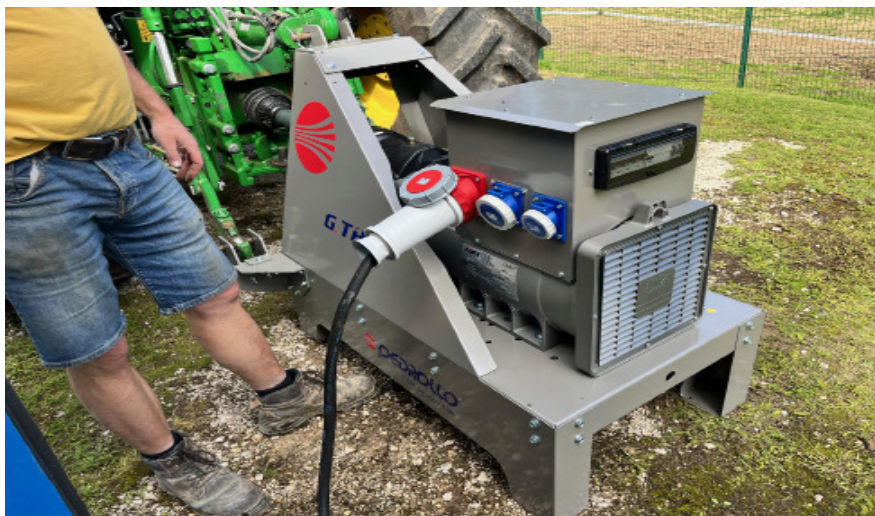
Installation d'une génératrice de force motrice, destinée à assurer une alimentation électrique de secours afin de maintenir la continuité du service en cas de coupure d'électricité.
